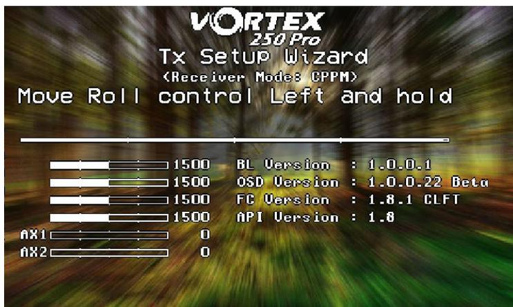
Следуйте инструкциям на экране, убедитесь, что каждый раз перемещаете правильную ручку управления. При назначении каждого элемента управления названия появятся слева от строки сервопривода.
