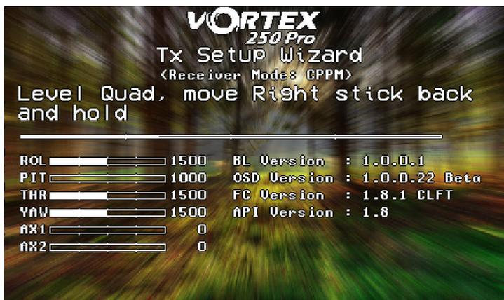
*Примечание:* чтобы перезагрузить мастер установки, включите коптер, нажмите и удерживайте кнопку на светодиодной панели, пока не раздастся два звуковых сигнала (первый через ~3 с, второй - через ~5 с). Также вы можете войти в мастер установки с помощью графического меню.
